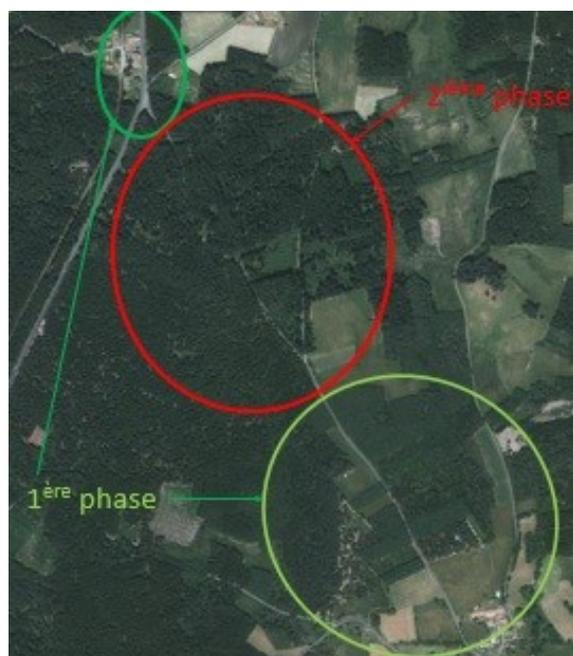
Les travaux seront réalisés en deux phases. La première tranche, qui a débuté, consistera à déplacer le poteau incendie de Bréchnignac, changer le poteau incendie de Malaguet, poser une canalisation sous la route départementale à Malaguet et poser une nouvelle canalisation sur 800 Mètres à partir de Bréchnignac. Durant la deuxième tranche, sera posée la fin de la canalisation vers Malaguet.
